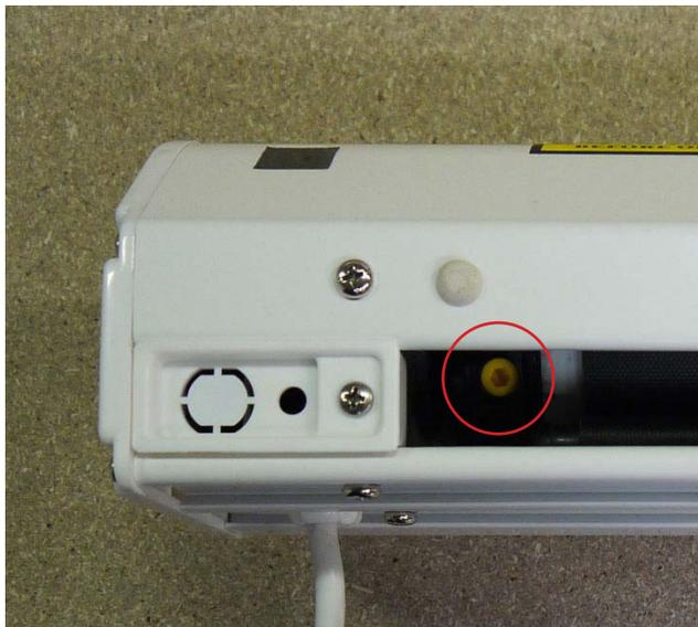
2\_ Retirer l'opercule d'accès à la seconde vis (grise).
